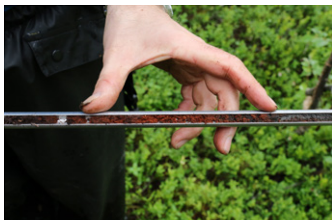
Figur 2: Myrmalm er den viktigste ingrediensen i tidlig jernproduksjon, sammen med vedtrekull. Myrmalm ble gravd opp av myrer, tørket og deretter røstet (brent) for å gjøre den så ren som mulig. Den røstede malmen ble lagt i blesterovnen sammen med trekull. Ved hjelp av blåsebelger nådde man høy nok temperatur til å skille slagget ut fra jernet. Foto: Eivind Unsmo.
