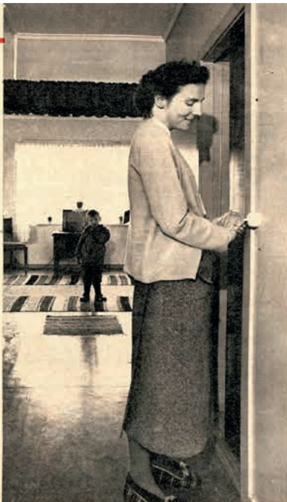
Hver detalj i huset er planlagt med omhu. Lysbryterne sitter så lavt at fru Tømmervold kan nå dem uten å løfte armene. Skyvedører og golv uten dørstokker gjør det lett å bevege seg.
