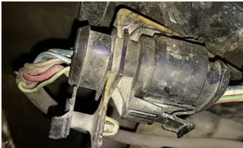
Sjekk hoved el-kontaktens ledninger, en typisk felle, som også et verksted kan overse!
