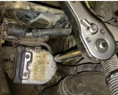
Skikkelig momentverktøy og WD40 er et must for å overtale gamle skruer som sitter stempla!
