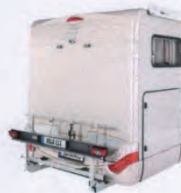
VELO - sykelholder Fleksibel lasteholder til 2 eller 3 sykler. Oppfellbar og avlagbar. Festet til rammeenden.
