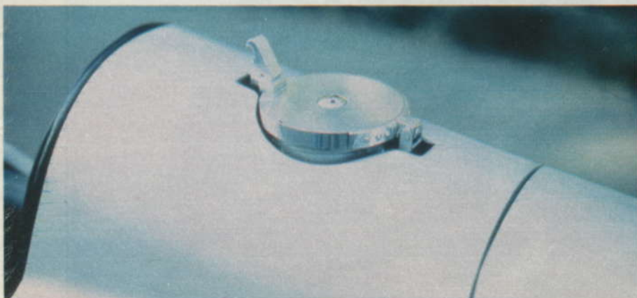
● Bränsletanken låg mellan sittbrunnen och motorn. Vid depåstoppen brukade man kasta en fuktig duk över förarens axlar för att skydda honom mot spillbensin.
