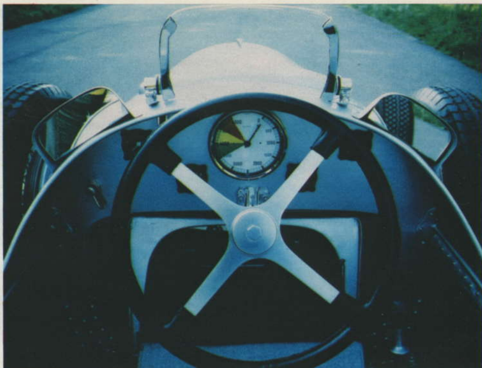
● Den stora motorn var inte precis högvarvig, toppeffekten utvecklades vid 5 000 r/m och varningsmarkeringarna började långt tidigare.
