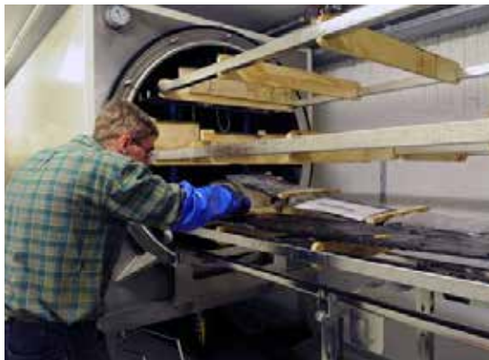
Bilde. NMMs frysetørkingsanlegg beregnet på deler fra Barkode-Båtene i Bjørvika. Foto: Sarah Fawsitt (NMM.)
