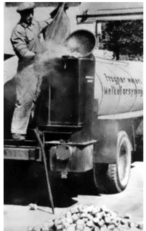
MELKETANKBIL: Bjerke var tidlig ute med tankbiltransport av melk. Allerede i 1939 gikk denne Federal'en i rute fra Frogner Meieri til Melkeforsyningen i Oslo. Her fyller Kristian Bjerke knott på generatoren. Legg merke til stakestokken som var et nødvendig hjelpemiddel for å holde prosessen i gang. På bakken ligger løs knott, som var små stykker av løvved. Foto fra 1943 eller 1944.
