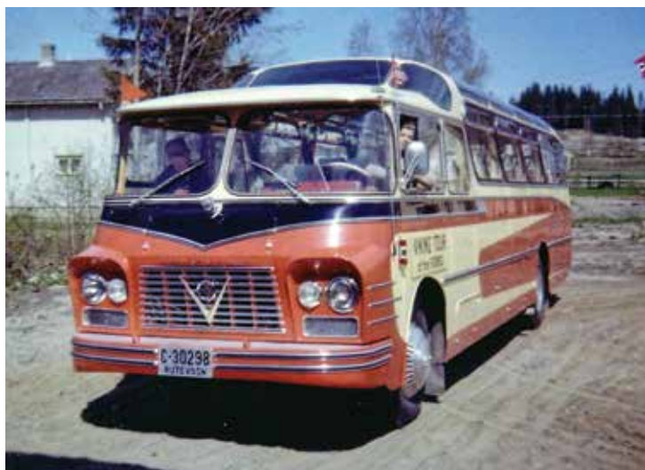
FLAGGSKIP: Bjerkes Rutebiler hadde en av de mest spesielle turbusser som ble bygd i Norge, en 1962 Volvo med «Strada» karosseri i italienskinspirert design fra Lier Karosserifabrikk. Bare åtte slike busser ble bygd. Her var det blant annet flystoler, kjøleskap og radio- og båndspilleranlegg. Oddvar Bjerke var fast sjåfør på denne vogna de første årene. Bussen fikk en «pensjonisttilværelse» som rutebuss med fast avgang fra Lørenfallet til Oslo kl. 6:30. Fast sjåfør var da Ole Petter Bjerke. Bussen var lett gjenkjennelig for passasjerene, så skilt som viste hvor den skulle, var unødvendig. Passasjerene not turist-komfort, men de frøs om vinteren. Bussen var bygd for sommerbruk og dårlig isolert. Den ble derfor tatt ut av rutetrafikken og solgt til et busselskap i Trysil i 1974.
