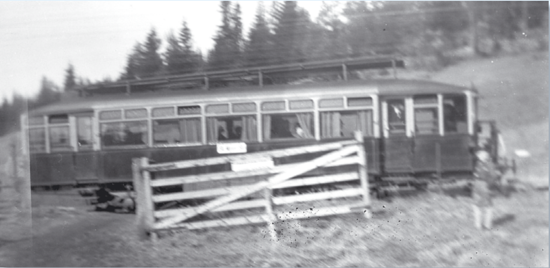
Langli stoppested ble etablert i 1932. På bildet vises en spesiell vogntype som ble produsert i Tyskland fra 1924. Vogna hadde forbrenningsmotor og skulle være økonomisk i drift. Imidlertid varte denne vogntypen ikke i så mange år. Foto: Ski historielag.
