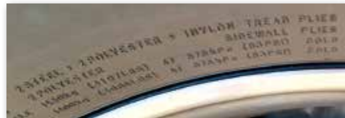
Hvor på dekketsiden man finner maks dekktrykk og maks dekklast for singel eller tvillinghjul Trykk i kpa og psi. Last i kg. og LBS.
