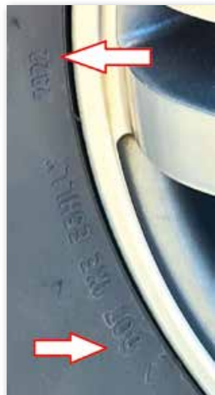
Hvor på dekket man finner datomerking 4 siffer ofte i nærheten av DOT merke.
