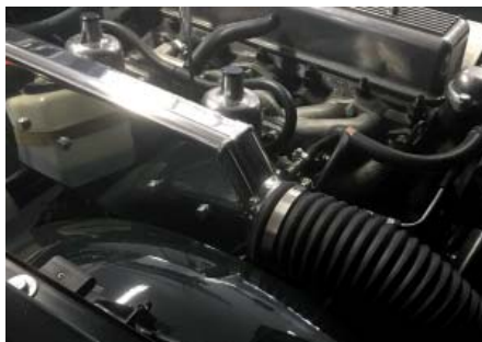
Forskjellige løsninger forsøkt. Øverst: EFI, den endelige løsningen Nr. 2: Den opprinnelige utførelsen med to Stromberg-forgassere. Nr. 3: To nye SU-forgassere Nr. 4: De samme SU-forgasserne med plenumskammer.
