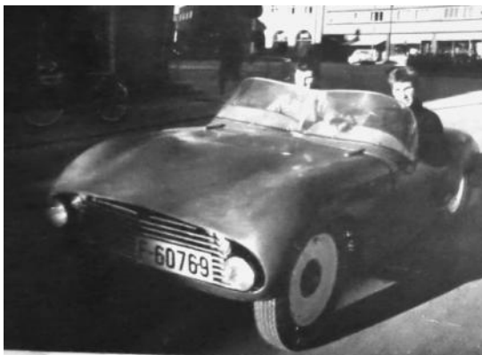
Brødrene Thoresen i sin hjemmebyggede BRT tidlig på 1960-tallet. Understellet er fra Fiat 500 1939-modell og motoren er fra Simca 1100.
