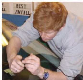
Kjetil Orebråten reparerer en steinsprutskade
