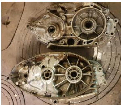
Blokkhalvdelene ble varmet på ovnen for å få ut gamle lagre.
