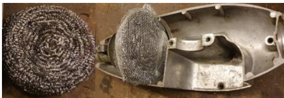
En gryteskrubb , litt myggnetting og ståltråd ble til et luftfilter
