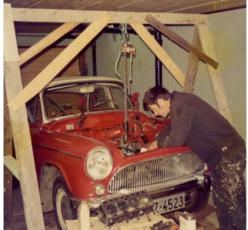
Arne Løvold skiftet topp, kløtsj og overhølte girkassa i 1974
