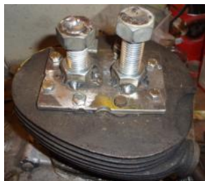
Pressverktøy til å få ut fastrustedede stempler
