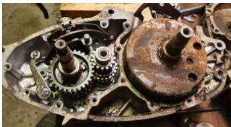
Stripa på veivakslingen viser vannstanden i veivhuset. Girkassa hadde heldigvis unngått vannskader.
