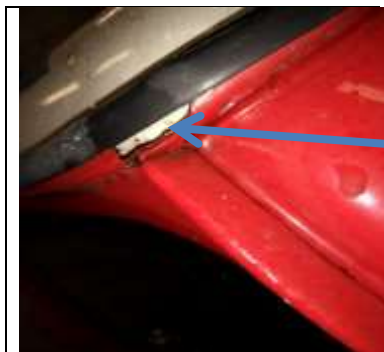
Fra 1979 ble drenshullet flyttet til rett over kantskjøten
