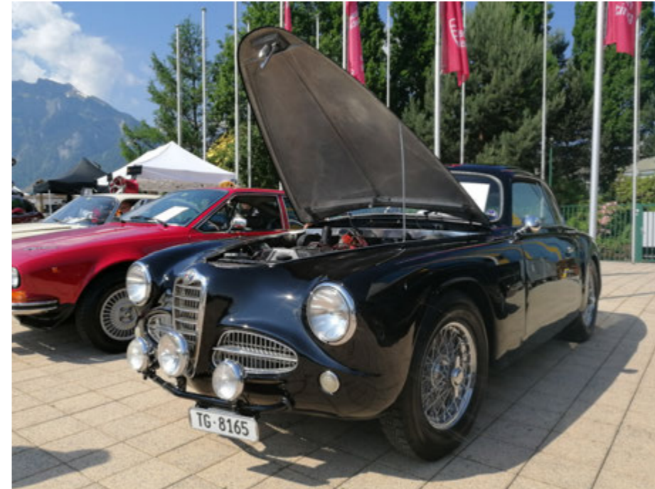
Over og under: En flott og sjelden 1900 C Sprint Touring, også omtalt som «1900 Superleggera». C'en står for corto, altså italiensk for kort, noe som indikerer at den har kortere akselavstand enn en standard 1900.
