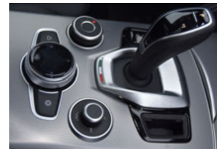
Sikre tegn på MY20 er tricoloren (over) og oppdatert infotainmentsystem med berøringsskjerm (under).
