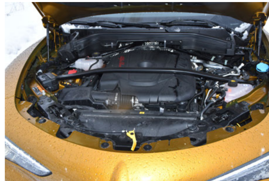
Dieselmotoren i Stelvio gir deg 0.2 til 0.25 liter lavere forbruk pr. mil, men krever bytte av registerreim etter fire år eller 60 000 km.
