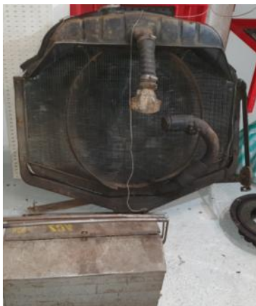
Et kjøleveskevolum på 26 liter krever en stor radiator
