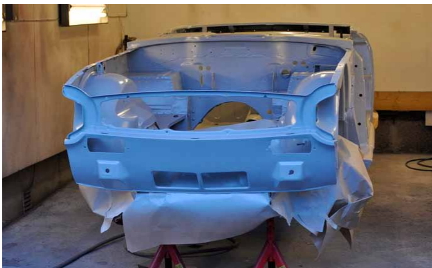
Karosseriet på egne hjul igjen for transport til lakkering. Høyre dør krevde en større oppretingsjobb, der var det mye plast Som det framgår av bildet over var den originale grunnningen i innerskjermen helt inntakt. Under er det like før doningen blir grønn, og spenningen stiger.
