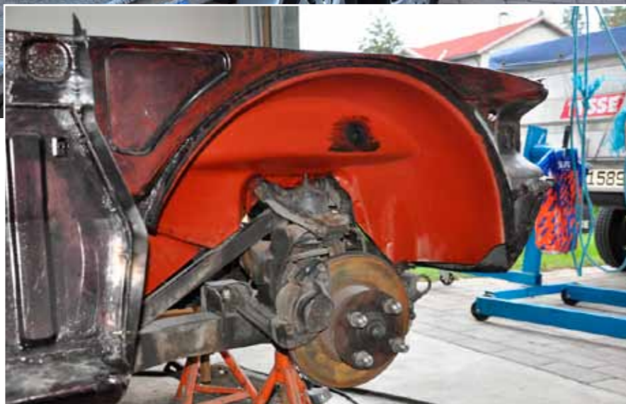
Karosseriet på egne hjul igjen for transport til lakkering. Høyre dør krevde en større oppretingsjobb, der var det mye plast Som det framgår av bildet over var den originale grunnningen i innerskjermen helt inntakt. Under er det like før doningen blir grønn, og spenningen stiger.
