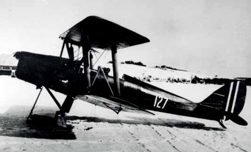
Dette er et De Havilland DH.82 Tiger Moth tilsvarende flyet som havarerte og som var produsert på Hærens Flyvemaskinsfabrikk på Kjeller. Foto: Norsk Teknisk Museum.
