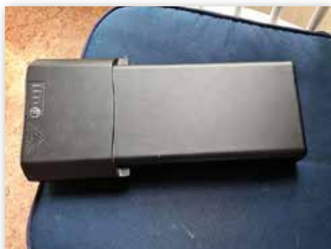
Batteriet, utseendemessig likt mange batteri, men Volt, fysiske mål, stikkeforbindelser og kapasitet kan ha mange varianter.
