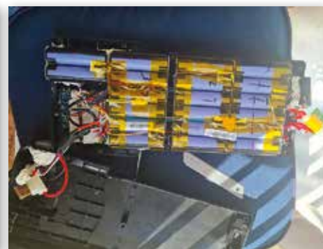
Batteri åpnet og lednings og stikkeforbindelser til BMS koples fra og til etter en stund.
