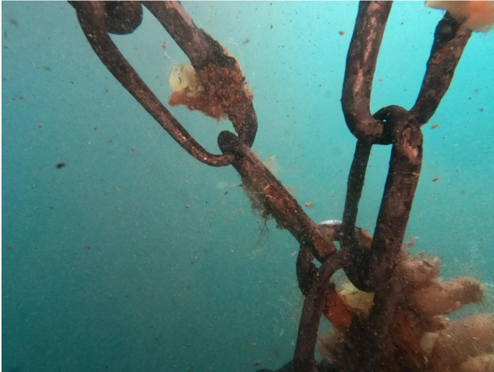
Bilde 4 – Eksempel på slitasje hvor kjettinger er i kontakt med hverandre.
