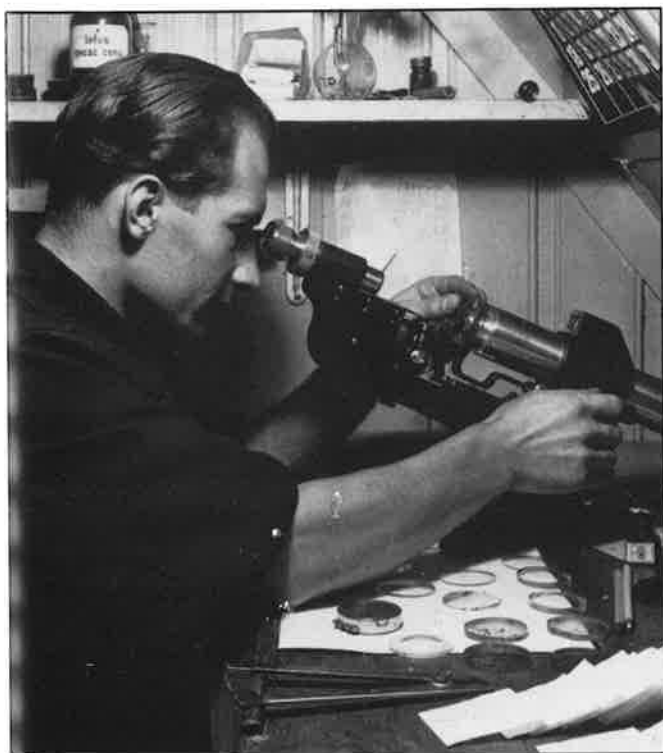
År 1949. Fra det første sliperiet i Storgt. 20, bryggerhuset i bakgården. F. Kulisek måler styrken på brilleglass.
