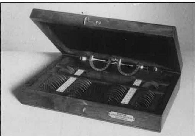
Prøvekasse som vi laget uten ringer. Styrken på glasset skrev vi på med diamant. Styrkeområdet var fra minus 6.00.
