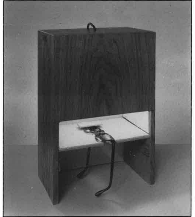
Varmekasse for oppvarming av brillefatninger.
