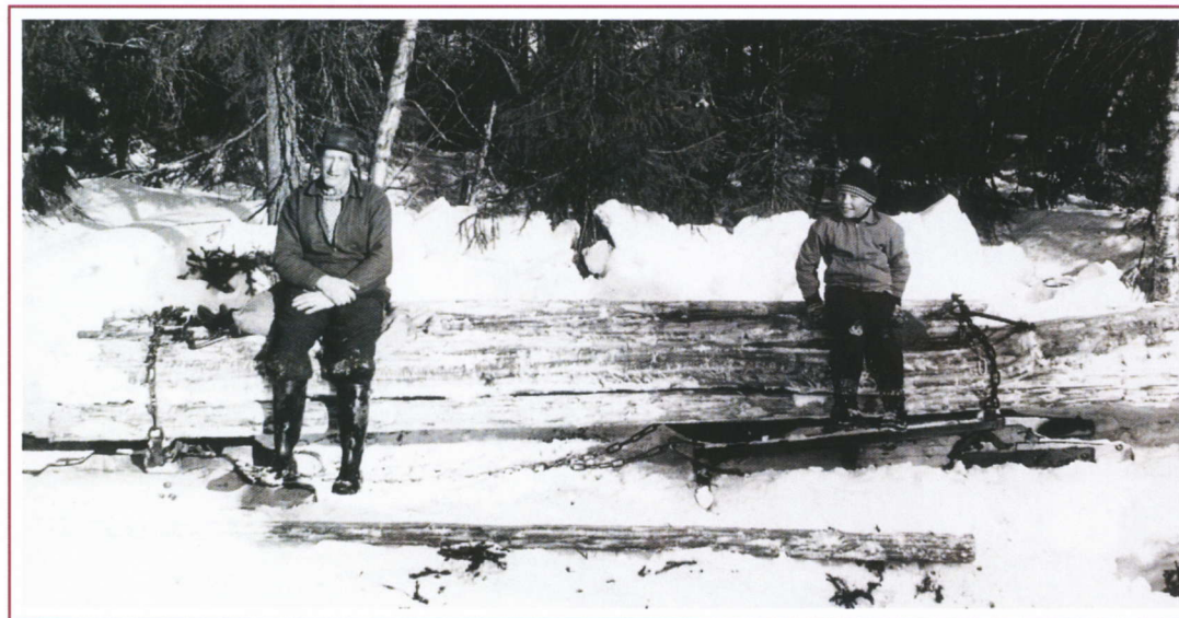
Lasset er ferdig lest. Stokkene ligger på bukken foran, der draget til hesten er festet, og bak ligger stokkene på geita . Lasset holdes sammen med kjetting foran og bak, kjettingen strammes med bjønn . Personene på bildene er Per Johnsen og yngstesønnen, Terje. Bildet er tatt ca 1957.
