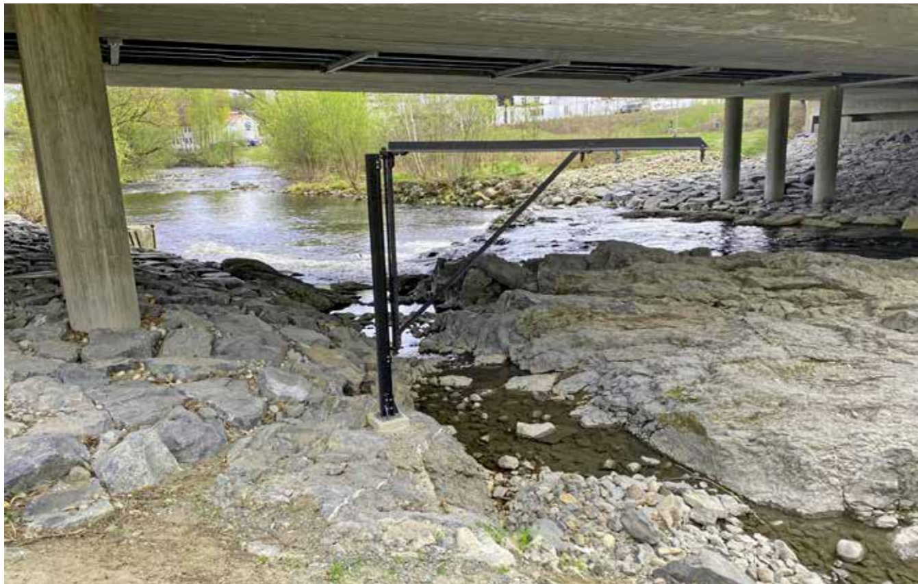
Den gamle, originale heiseinnretningen for teina står under Hamangbrua i dag. Her kunne man heise teina på plass i vannet eller heise teina på land når det var fisk i den, eller når den ikke skulle brukes. Foto Bo Wingård.
