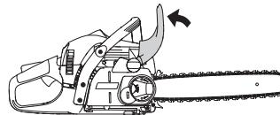
Lossa kedjespännskruven och ta av kopplingskåpan (kedjebromsen). Plocka av transportskyddet.
