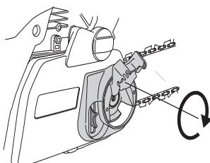
På en ny kæde skal kædestramningen kontrolleres ofte, indtil kæden er kørt til. Kontrollér kædestramningen regelmæssigt. Korrekt kæde betyder god skærekapacitet og lang levetid.
