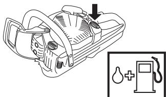
**ADVARSEL!** Brændstof og brændstofdamper er meget brandfarlige. Vær forsigtig ved håndtering af brændstof og kædeolie. Tænk på brand-, eksplosions- og indåndningsrisici.
