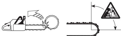
Å sage med sverdets underside, dvs. å sage fra sagobjektets overside og ned, kalles å sage med dragende sagkjede. Da dras motorsagen mot treet, og motorsagkroppens forkant blir en naturlig støtte mot stammen. Saging med dragende sagkjede gir brukeren bedre kontroll over motorsagen og over hvor sverdets kastrisikosektor befinner seg.
