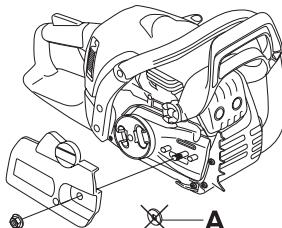
Asenna terälevy teräpultteihin. Aseta terälevy takimaiseen asentoonsa. Aseta ketju ketjupyörälle ja terälevyn ohjausuraan. Aloita terälevyn yläpuolelta.
