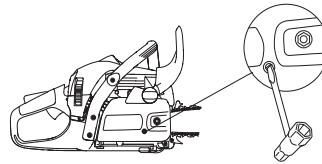
Kedjan är korrekt spänd när den inte hänger slak på svärdets undersida och fortfarande kan dras runt lätt för hand. Drag fast svärdsmuttrarna med kombinyckeln samtidigt som svärdsspetsen hålls upp.
