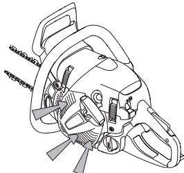
**VIGTIG!** For å opprettholde centrifugalrensingens funksjon, må den rengjøres og vedlikeholdes kontinuerlig. Rengør luftinntaket til startmotoren, vifteskovlene på svinghjulet, rommet rundt svinghjulet, intaktsrøret og forgasserrommet.
