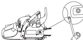
Ketjun kireys on oikea, kun se ei roiku löysällä terälevyn alapuolella ja liikkuu kevyesti käsin pyöritettäessä. Kiristä terälevyn mutterit yhdistelmäävaimella pitäen samalla terälevyn kärkeä ylhäällä.
