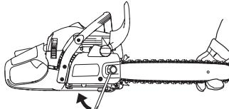
På en ny kæde skal kædestramningen kontrolleres ofte, indtil kæden er kørt til. Kontrollér kædestramningen regelmæssigt. Korrekt kæde betyder god skærekapacitet og lang levetid.
