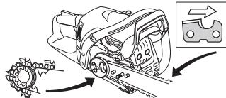
Tarkasta, että hammaslenkkien teräsärmät ovat eteenpäin terälevyn yläpuolella.
