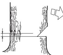
Sätt i barkstödet (om något är påmonterat) bakom brytmånen. Såga med fullgas och för sågkedjan/svärden sakta in i trädet. Var observant på om trädet rör sig i motsatt riktning till vald fallriktning. Sätt i en fällkil eller ett brytjärn i fällskäret så snart skärdjupet tillåter.
