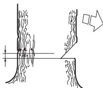
Placer barkstøtten (hvis den er monteret) bag brudpunktet. Sav med fuld gas, og før savkæden/sværdet langsomt ind i træet. Vær opmærksom på, om træet bevæger sig i modsat retning i forhold til den valgte faldretning. Sæt en fældekile i eller et brækjern i fældesnittet, så snart snittybden tillader det.
