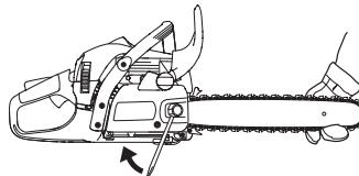
På et nytt kjede må kjedespenningen kontrolleres ofte til kjedet er kjørt inn. Kontroller kjedespenningen regelmessig. Riktig kjede betyr god skjærekapasitet og lang levetid.
