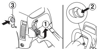
Grip det fremre håndtaket med venstre hånd. Sett høyre fot på underdelen av det bakre håndtaket, og press motorsagen mot bakken. Grip starthåndtaket, dra startsnoren langsomt ut med høyre hånd til du merker motstand (starthakene griper), og dra deretter med raske og kraftfulle rykk til motoren tenner (4).
