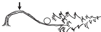
Avgör hur du säkra frigör spänningen och om du klarar av att göra det. Vid extra komplicerade situationer är den enda säkra metoden att avstå från motorsågsanvändning och använda en vinsch.
