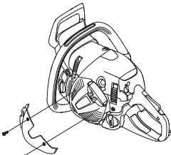
**BEMÆRK!** Hvis der er monteret et speciel vintersæt eller foretaget temperaturforhøjende foranstaltninger, skal der foretages omstilling til normale forhold, når maskinen skal benyttes ved normale temperaturer. Ellers risikerer man overopvarmning med svære motorskader til følge.
