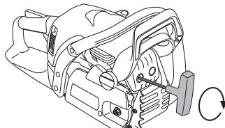
Visse lyddæmpere er udstyret med et specielt gnistfangernet. Hvis din maskine er udstyret med en sådan lyddæmper, bør nettet rengøres en gang om ugen. Dette gøres bedst med en stålborste. Et tilstoppet net medfører, at motoren kører varm med alvorlig motorskade til følge.
