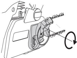
På et nytt kjede må kjedespenningen kontrolleres ofte til kjedet er kjørt inn. Kontroller kjedespenningen regelmessig. Riktig kjede betyr god skjærekapasitet og lang levetid.
