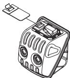
Lyddemperen er utformet for å dempe lydnivået og for å lede avgassene bort fra brukeren. Avgassene er varme og kan inneholde gnister som kan forårsake brann hvis gassene rettes mot et tørt og brennbart materiale.
