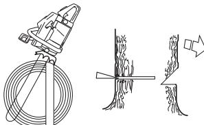
Fældesnittet skal afsluttes parallelt med retningssnittlinjen, så afstanden mellem de to er mindst 1/
