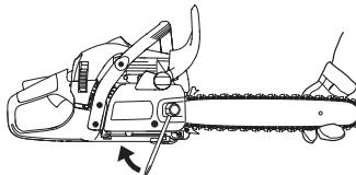
Uuden ketjun kireys on tarkastettava usein ketjun sisäänajon aikana. Tarkasta ketjun kireys säännöllisesti. Oikein kiristetty ketju takaa hyvän leikkutehon ja pitkän kestoiän.
