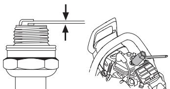
Bemerk! Brug altid anbefalet tændrørstype! Forkert tændrør kan ødelægge stempel/cylinder. Kontroller, at tændrøret har såkaldt radiostøjdæmpning.
