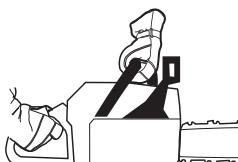
Gi full gass og aktiver kjedebremsen ved å vri venstre håndledd mot kastbeskyttelsen. Ikke slipp det fremste håndtaket. **Kjedet skal stanse umiddelbart.**
