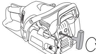
Noen lyddempere er utstyr med et spesielt gnistfangernett. Hvis maskinen er utstyr med en slik lyddemper, bør nettet rengjøres en gang i uken. Dette gjøres enklast med en stålborste. Et tilstoppet nett fører til at motoren går varm med alvorlig motorskade som følge.
