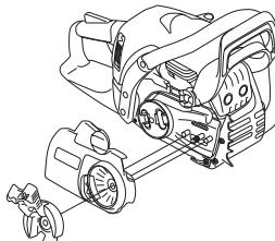
Asenna terälevy teräpultteihin. Aseta terälevy takimaiseen asentoonsa. Aseta ketju ketjupyörälle ja terälevyn ohjausuraan. Aloita terälevyn yläpuolelta.
