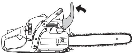
**använda detta grepp.** Håll ett stadigt grepp så att tummarna och fingrarna omsluter motorsågens handtag.
