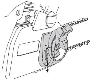
Ketju on oikein kiristetty silloin, kun se ei roiku laipan alapuolella, mutta liikkuu kuitenkin helposti kädellä siirrettäessä. Pidä laipan kärkeä ylhäällä ja kiristä laipan kiinnitys käintämällä väennintä myötäpäivään.
