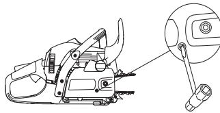
Kæden er korrekt spændt, når den ikke hænger slapt ned på sværdets underside og stadig kan trækkes rundt med hånden. Spænd sværdmøtrikkerne fast med kombinøglen, samtidig med at sværdspidsen holdes opad.
