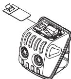
Lyddæmperen er beregnet til at dæmpe lydniveauet og til at lede udstødningsgasserne væk fra brugeren. Udstødningsgasserne er varme og kan indeholde gnister, som kan forårsage brand, hvis udstødningsgasserne rettes mod et tørt og brændbart materiale.
