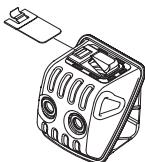
Ljuddämparen är utformad för att dämpa ljudnivån och för att leda avgaserna bort från användaren. Avgaserna är heta och kan innehålla gnistor vilka kan orsaka brand om avgaserna riktas mot ett torrt och brännbart material.
