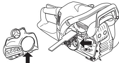
Kontroller jevnlig at bremsebåndet er minst 0,6 mm tykt på det mest slitte stedet.
