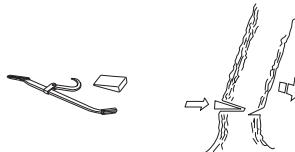
Vi rekommenderar användande av en svärdslängd som överstiger trädets stamdiameter, så att fäll- och riktskär kan utföras med ett s.k. "enkelt sågsnitt". Se anvisningar under rubrik Tekniska data angående vilka svärdslängder som rekommenderas för din motorsågsmodell.
