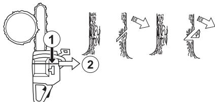
Dybden på styreskåret skal være 1/4 av stammens diameter og vinkelen mellom over- og underskjær minst 45°.
