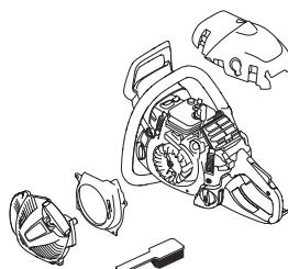
Rens kølesystemet med en børste en gang om ugen, under støvfylde forhold oftere. Et snavset eller tilstoppet kølesystem medfører overopvarmning af maskinen med skader på cylinderen og stemplet til følge.
