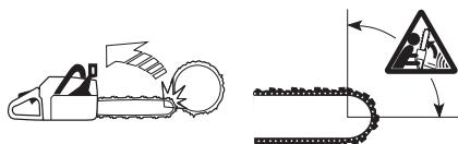
Kast färdas alltid i svärdsplanets riktning. Vanligast är att motorsåg och svärd kastas uppåt och bakåt mot användaren. Dock förekommer andra kastriktningar
