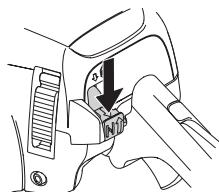
Motoren standses ved at trykke start/stop-knappen ned.
