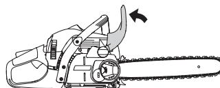
Løsne kjedestammerhjulet og ta av koplingsdekselet (kjedebremsen). Ta av transportbeskyttelsen.
