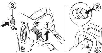
Fatta om främre handtaget med vänster hand. Placer höger fot på underraden av bakre handtaget och tryck motorsågen mot marken. Grip starthandtaget, drag med höger hand långsamt ut startlinan tills ett motstånd känns
