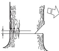
Sett i barkstøtten (hvis en slik er montert) bak brytekanten. Sag med full gass og før sagkjedet/sverdet sakte inn i treet. Vær på vakt mot at treet beveger seg i motsatt retning av det som er valgt som fallretning. Sett en fellekile eller et brytejern i hovedskåret så snart skjæredybden tillater det.
