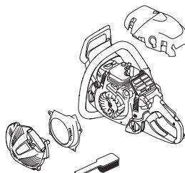
Rengjør kjølesystemet med en børste en gang i uken, ved vanskelige forhold oftere. Et tilmusset eller tett kjølesystem fører til at maskinen overoppphetes, noe som forårsaker skader på sylinder og stempel.
