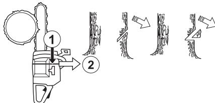
Retningssnittybden skal være 1/4 af stammens diameter, og vinklen mellem over- og undersnit skal være mindst 45°.
