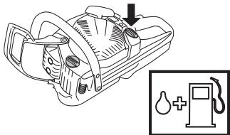
**VARNING!** Bränsle och bränsleångor är mycket brandfarliga. Var försiktig vid hantering av bränsle och kedjeolja. Tänk på brand-, explosions- och inandningsrisker.
