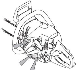
TÄRKEÄÄ! Keskipakoispuhdistuksen tehon säilyttämiseksi on huolehdittava säännöllisestä huollosta. Puhdista käynnistimen ilmanottoaukot, vauhtipyörän tuuletinsiivet, vauhtipyörän ympäristö, imuputki ja kaasutintila.
