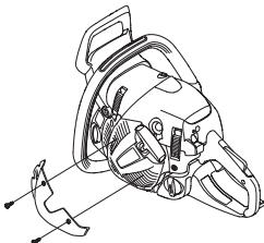
HUOM! Jos koneeseen on asennettu erityinen talivarustus tai sen käyntilämpötilaa on nostettu, täytyy varustus poistaa ja säädöt palauttaa entiselleen, ennen kuin konetta aletaan käyttää normaaleissa lämpötiloissa. Muussa tapauksessa moottori voi ylikuumeta, mistä seuraa vakavia moottorivaurioita.
