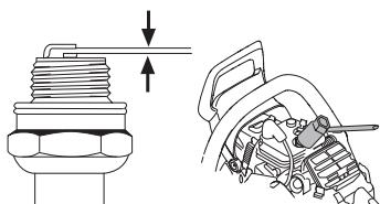
Notera! Använd alltid rekommenderad tändstiftstyp! Felaktigt tändstift kan förstöra kolv/cylinder. Se till att tändstiftet har s.k. radioavstörning.
