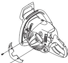
**OBS!** Hvis der er montert et spesielt vintersett eller det er gjort noe for å heve temperaturen, må maskinen omstilles til normal innstilling når den brukes i normale temperaturforhold. Ellers risikerer man overoppfeting med alvorlige motorskader som resultat.
