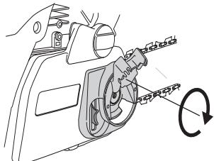
Uuden ketjun kireys on tarkastettava usein ketjun sisäänajon aikana. Tarkasta ketjun kireys säännöllisesti. Oikein kiristetty ketju takaa hyvän leikkuutehon ja pitkän kestojan.
