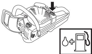
**ADVARSEL!** Brennstoff og brennstoffdamp er meget brannfarlig. Vær forsiktig ved håndtering av brennstoff og kjedeolje. Husk brann-, eksplosjons- og innåndingsfare.
