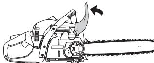
Irrota ketjunkiristyspyörä ja otta kytkinkotelo (ketujarru) pois. Ota kuljetussuoja pois.
