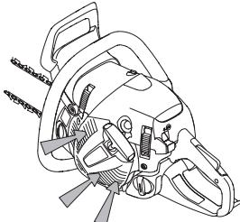
**VIGTIGT!** For at bevare centrifugalrensningens funktion skal man udføre kontinuerlig pleje og vedligeholdelse. Rens startaggregatets luftindtag, svinghjulets ventilatorflanger, området omkring svinghjulet, indugsningsrøret og karburatorrummet.
