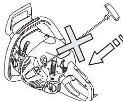
**Notera!** Återställ kedjebromsen genom att föra kastskyddet mot handtagsbygeln. Motorsågen är härmed klar för användning.
