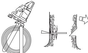
Hovedskåret skal avsluttes parallelt med styreskårlinen slik at avstanden mellom dem er minst 1/10 av stammens diameter. Den delen av stammen som ikke er gjennomsagd, kalles brytekant.
