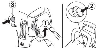
Grib om det forreste håndtag med venstre hånd. Sæt højre fod på underdelen af de bageste håndtag og pres motorsaven ned mod jorden. Tag fat i starthåndtaget, træk startsnoren langsomt ud med højre hånd, indtil der kan mærkes modstand (startkrogene går i indgreb), og
