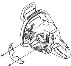
**OBS!** Är speciell vintersats monterad eller temperaturhöjande åtgärder vidtagna, måste omställning ske till normal inställning, då maskinen användes under normala temperaturförhållanden. I annat fall riskeras överhettning med svåra motorskador som följd.
