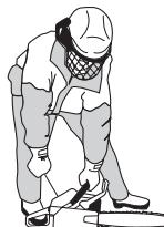
Trykk inn choken umiddelbart når motoren tenner og gjør flere startforsøk til motoren starter. Når motoren starter gir du raskt full gass, og startgassen koples ut automatisk.
