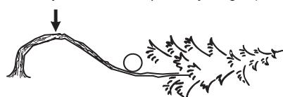
Avgrörd hur du säkrast frigör spänningen och om du klarar av att göra det. Vid extra komplicerade situationer är den enda säkra metoden att avstå från motorsågsanvändning och använda en vinsch.
