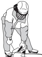
Tryk chokeren ind, så snart motoren tænder, og gør nye forsøg, indtil motoren starter. Når motoren starter, gives hurtig fuld gas, og startgassen kobles automatisk fra.
