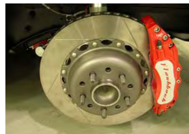
Venstre: Elektronikken krever plass. Det skal litt til for å stoppe 600Hp, todelte ventilerte skiver (Foto: Pat)
