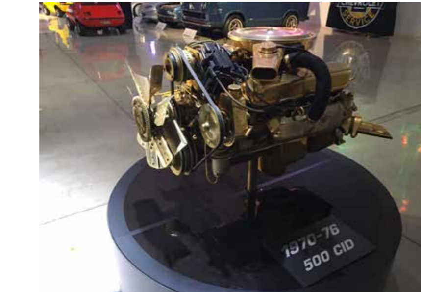
Cadillac 500 CID eller 8,2 liter holder rekorden som verdens største serieproduserte V8 motor monter i en serieprodusert bil. Grunnmodellen er den samme som Cadillac 472 og senere 425 CID
