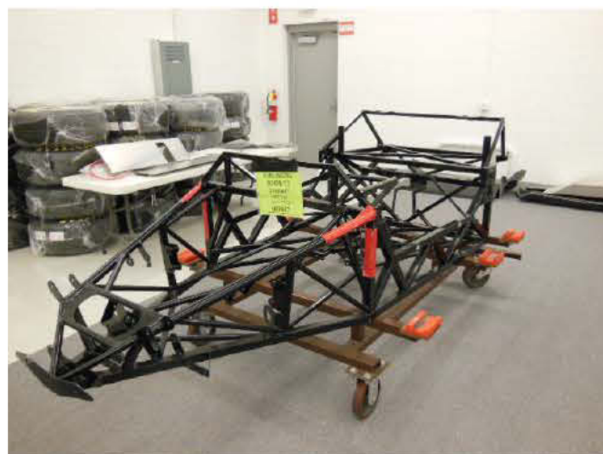
▲ En rørramme og ▼ løfte på karosseriet
