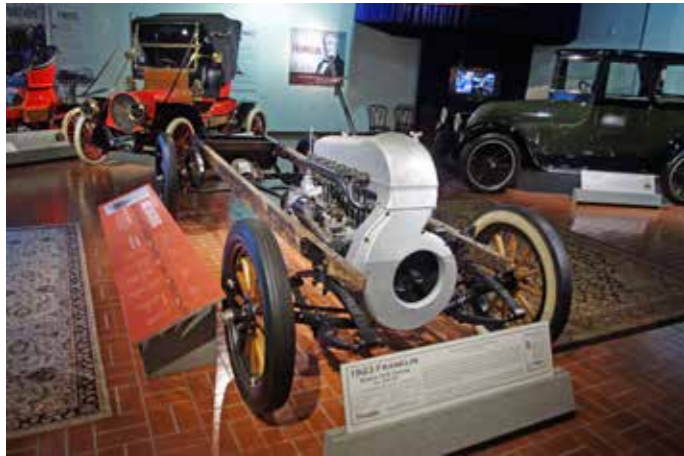
▲ Slik kan det også gjøres, 1923 Franklin Chassis med luftkjølt motor, legg merke til rammen som er gjort i «2" X 4"». Får du rust, nei, råde i ramma er det bare å stikke ned på Byggmax etter ny..
