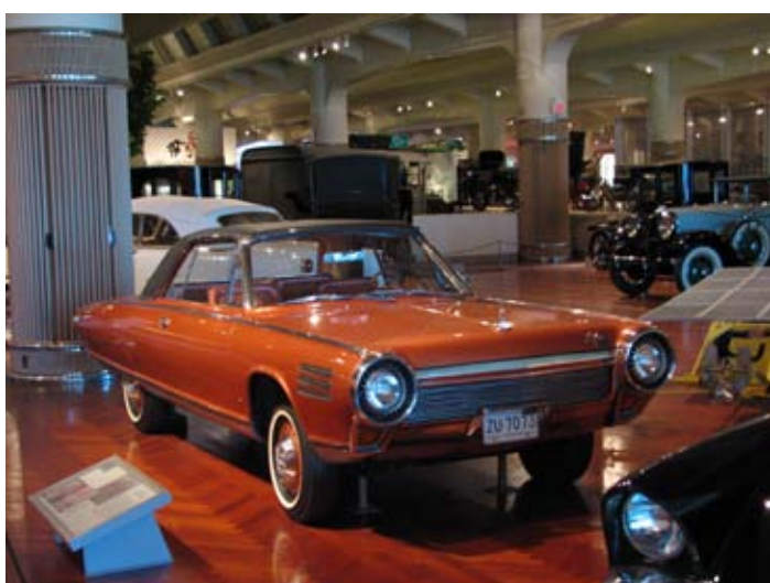
Flere av bilfabrikantene eksprimenterte med turbindrevne biler. Chrysler gjorde 55 av disse som gikk bokstavelig talt på alt som fløt og brant
