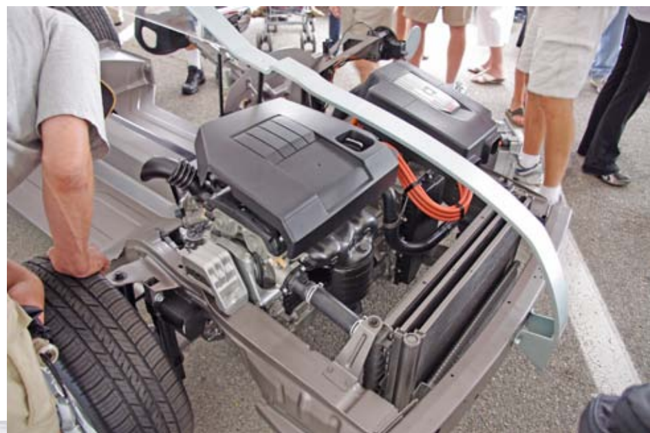
En «ribbet» Volt hvor man fikk se de ulike tekniske løsningene for chassiset. Under: Motor og generator for å lade batteriet når det går tomt. Billigere enn å bygge ut et omfattende nett for å lade el-biler
