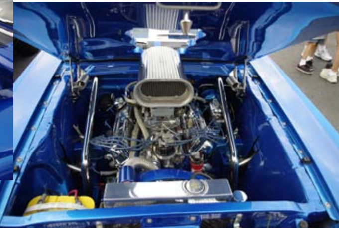
«Opphestet» motor, fronten bygget opp med rørramme.
