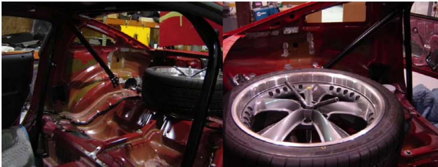
Firepunksburet er på plass i den ellers ribbede kupeen. Reservehjulet har fått sin egen plass og er lett tilgjengelig.
