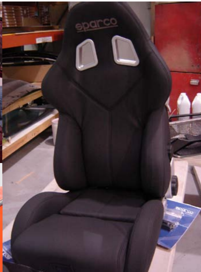
Når det skal gå fort skal man også gjerne sitte godt og stabilt. Originalsetene er byttet ut med skinnseter fra Sparco og firepunkts sikkerhetsbelter.
