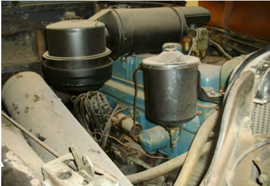
Buick rekkeåtter på 263cid med 129Hp, motoren ble benyttet i både Super og Special modellene. Motoren ble introdusert i 1950 Super og er en oppborret variant av Specials 248cid som kom i 1937. I 1951 delte Super og Special denne motoren. Super fikk i 1953 den nye V8 (Nailhead) mens Special beholdt F-263'n ut 1953.
