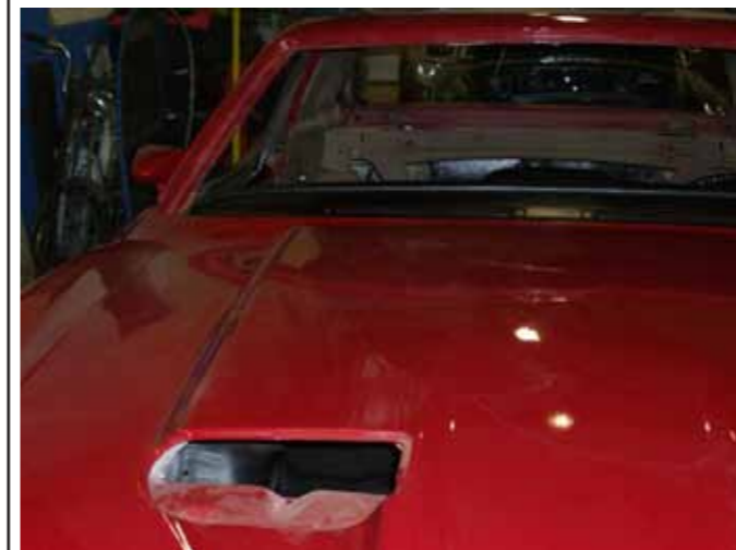
Ikke funksjonerende NASA Ram Air luftinntaket ble levert som «non cost» opsjon på biler med 302cid. Det fullt funksjonerende Ram Air panseret ble levert på biler med 351cid 4V motor.
