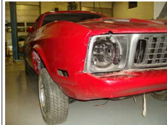
Det er ikke mye som skiller '71-'73 Mustang. For '73 modellen hadde man valgt å sette de kombinerte park- og blinklysene på høykant. Frontlyktene har fått krominramming. Fronten er også endret for å imøtekomme nye støtfangerkrav.
