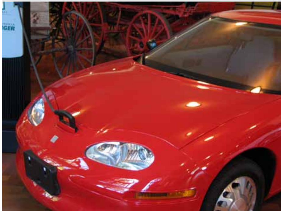
GM's EV1, med behendig ladetilkobling i grillen, EV1 var tilgjengelig fra 1996 til 1999 i California og Arizona. Man kunne kun få bilen på en begrenset tre år/30000 miles leasing. Produksjonen var 1117 enheter. Disse ble trukket fra markedet i 2003. Alle bilene ble skrotet, med unntak av noen få eksemplarer for utdanning og museer. Her fra Ford-museet. (Gunnar)
