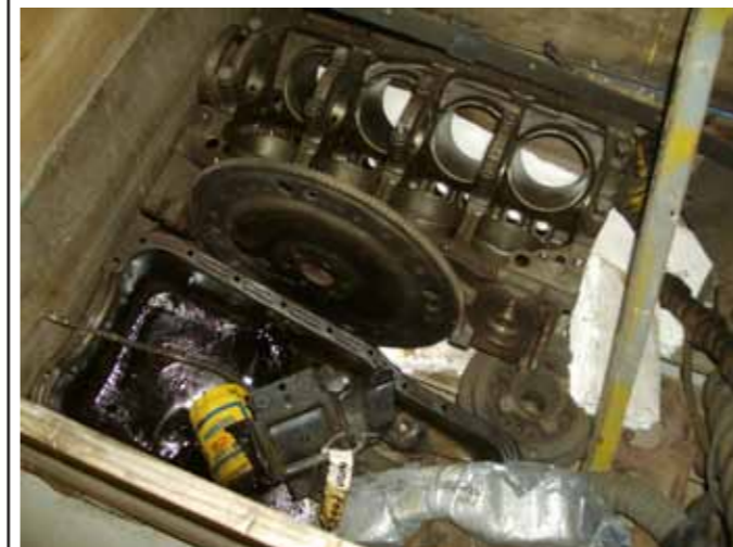
Tim's 302 i deler. Originalt er dette en motor med to-port forgasser og 141 hp. Selv om dette ikke høres imponerende ut skal man ikke glemme at fra og med modellåret '72 begynte man å oppgi motoreffekten i netto hester. Oppgitt i bhp vil motoreffekten være 210 hp
