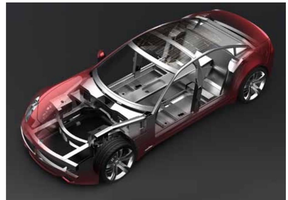
«Skjellettet» på en Karma 4-dørs sedan, aluminiumsproduzentenes våte drøm. Vekt er en viktig del når man skal få plass til både en batteripakke, motor, generator og drivstofftank. Under: Linjene avslører at Fisker har holdt på med design i en årrekke.
