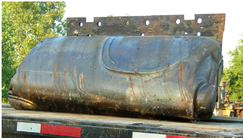
Man kan tydelig se linjene til forskjermene på B-siden av formen (Foto: Pat)
