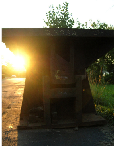
A-siden på verktøyet for forskjermene (Foto: Pat)
