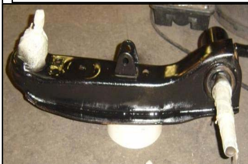
Bærebrua er lakkert, nye foringer er presset på av Magnus Motor AS. Nå er begge på plass
