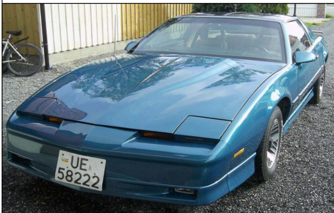
1984 mod. Pontiac Trans Am Recaro T/A Motor :78 mod. Bygd i 1995 , 355 cid. på 340 HK Girkasse : Hot-rod modifisert th 700 bygd av Rats i 2004 Ny front fra 1987 mod. + nye baklykter . Bilen ble plukket ned i vinter og lakkert opp i samme farge.
