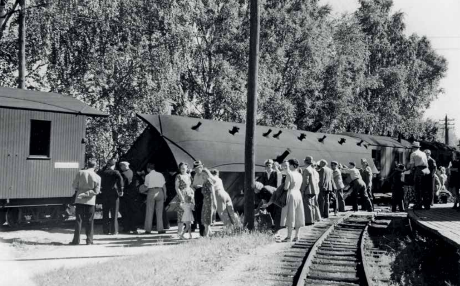
Vognvelt Sørumsand stasjon: Personvogn BCo3 har veltet på rampesporet på Sørumsand. Foto: Hermann Nordling, gjengitt med tillatelse fra Norsk jernbanemuseum, Hamar.
