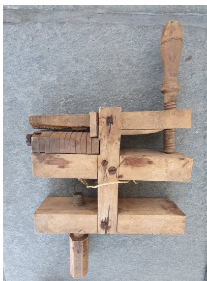
Reimdelar fra Finn Ruuds Garveri. En Reimdelar ble trolig brukt til å dele opp lærreimer som ble solgt til bruk i seletøy til hest.
