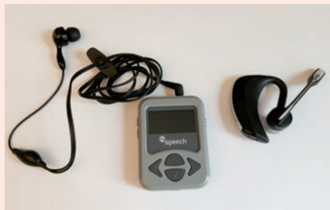
MySpeech festes i beltet eller plasseres trådløst i lommen. Til apparatet bruker man øretelefoner med mikrofon, eller en blåtansender.
