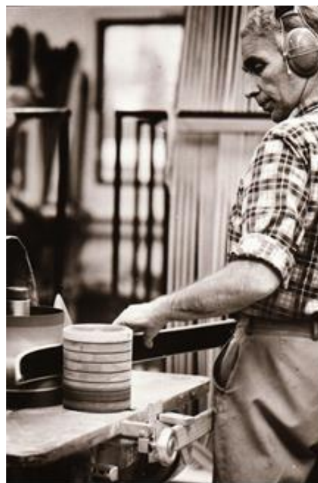
Bildet viser Birger Kongsgården som pusser undersålen på en ski. Bildet er sannsynligvis fra tidlig på 1970-tallet da Kongsberg fremdeles produserte treski.
