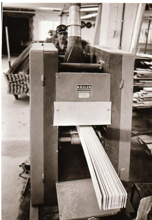
Kongsberg Skifabrikk fikk etter hvert en svært moderne maskinpark. Bildet viser Hellik Juvelid bak den moderne sagen som i én operasjon kutter en laminert blokk i et maksimalt antall «såler» i riktig tykkelse. Bildet er sannsynligvis fra 1973/74.
