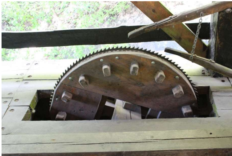
Foto 9. Kamhjulet/palhjulet på Gjersjøsaga.
