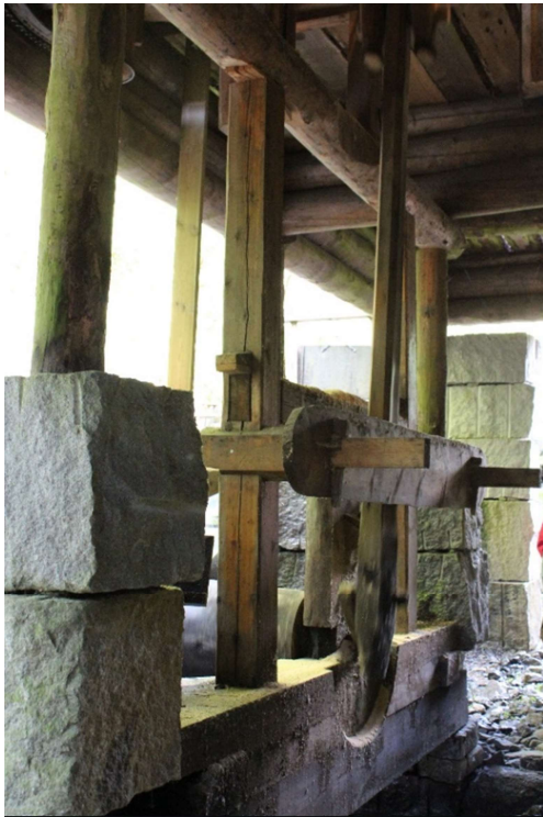
Foto 7: Her ser man veivstangen/krumstangen som er festet til sagramma. Vannhjulet som driver dette er skjult bak steinen i forkanten av bildet.
