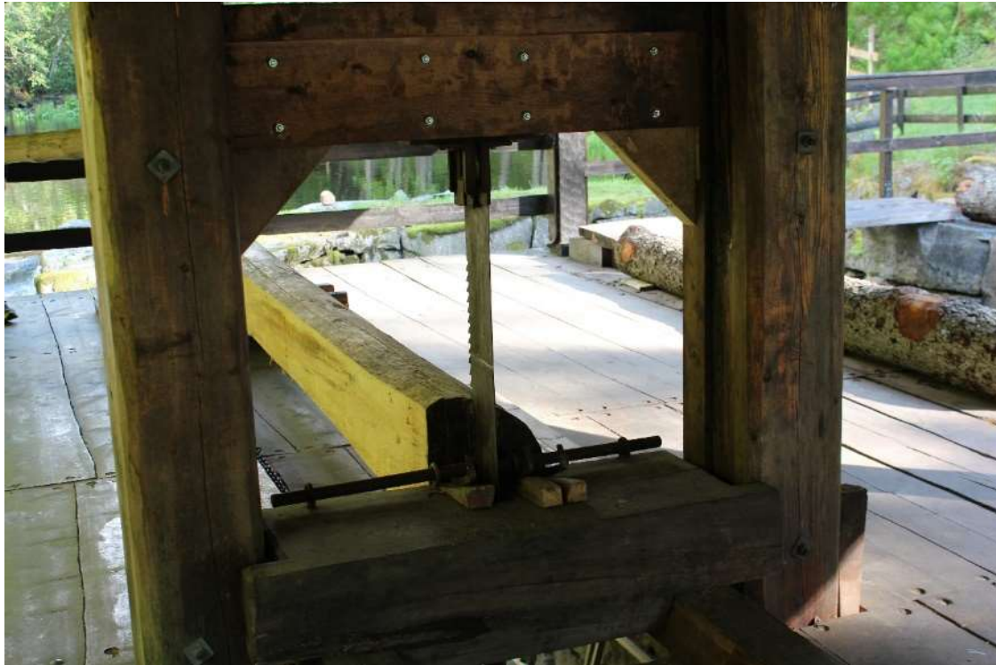
Foto 6: Foto viser sagbladet festet i saggrinda/sagramma klar for å sage stokken. Denne saggrinda har bare et sagblad. Foto fra Gjersjøsaga i Nordre Follo kommune.
