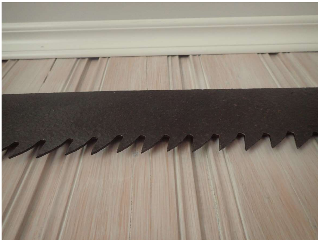
Foto 4 og Foto 5: Sagblad fra et privat hjem. Ukjent hvilken sag den kommer fra, men det er fra en av sagene i Byåa. Sagbladet er tykt og er derfor av den eldste typen, det vil si fra før 1750.
