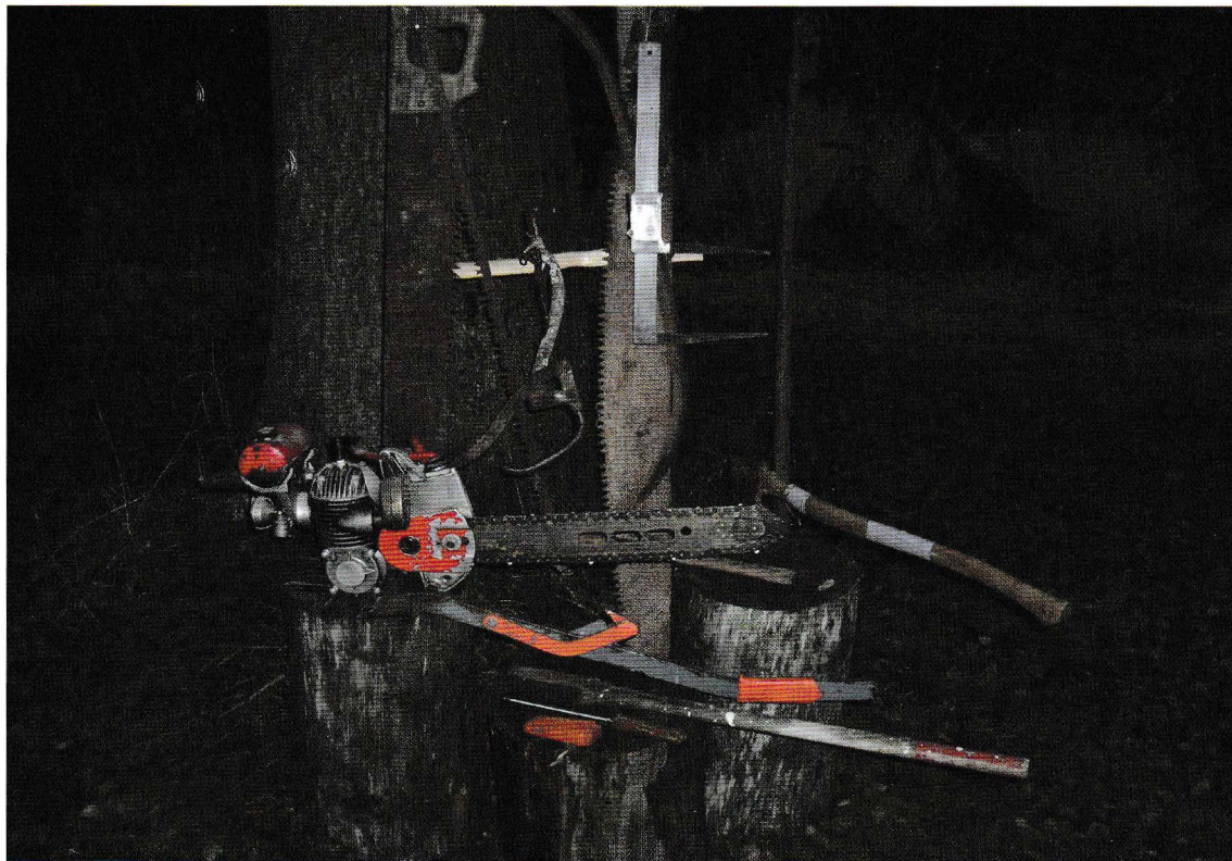
Gamle skogsredskaper; motorsag fra 1950, blinkeøks, tømmerklave, tømmerøks, bogesag, tigersvans og fjørsvans fra 1940-tallet.
