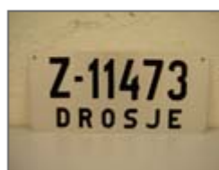
8. Kjennemerke med undertekst. Underteksten kan være: drosje, leievogn eller rutevogn. 180 x 400 mm.
