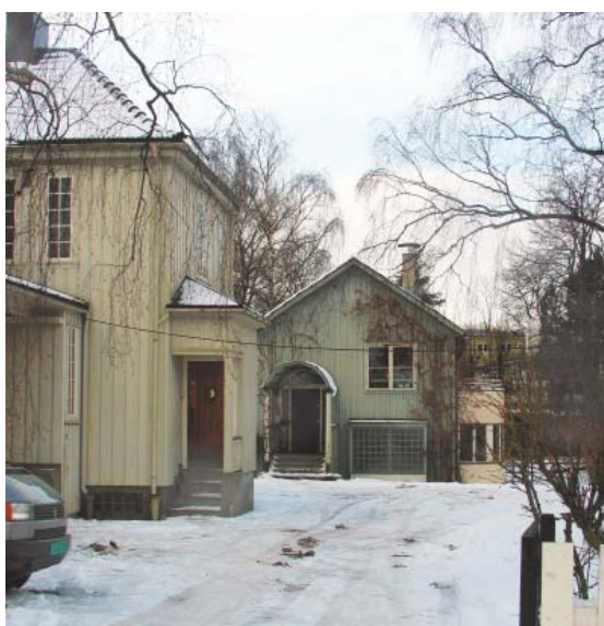
Fig.7.3 Gammel og ny bebyggelse samspiller når det gjelder takvinkel, fremskutt inngangsparti og materialbruk, uten å være like. Villaveien.
