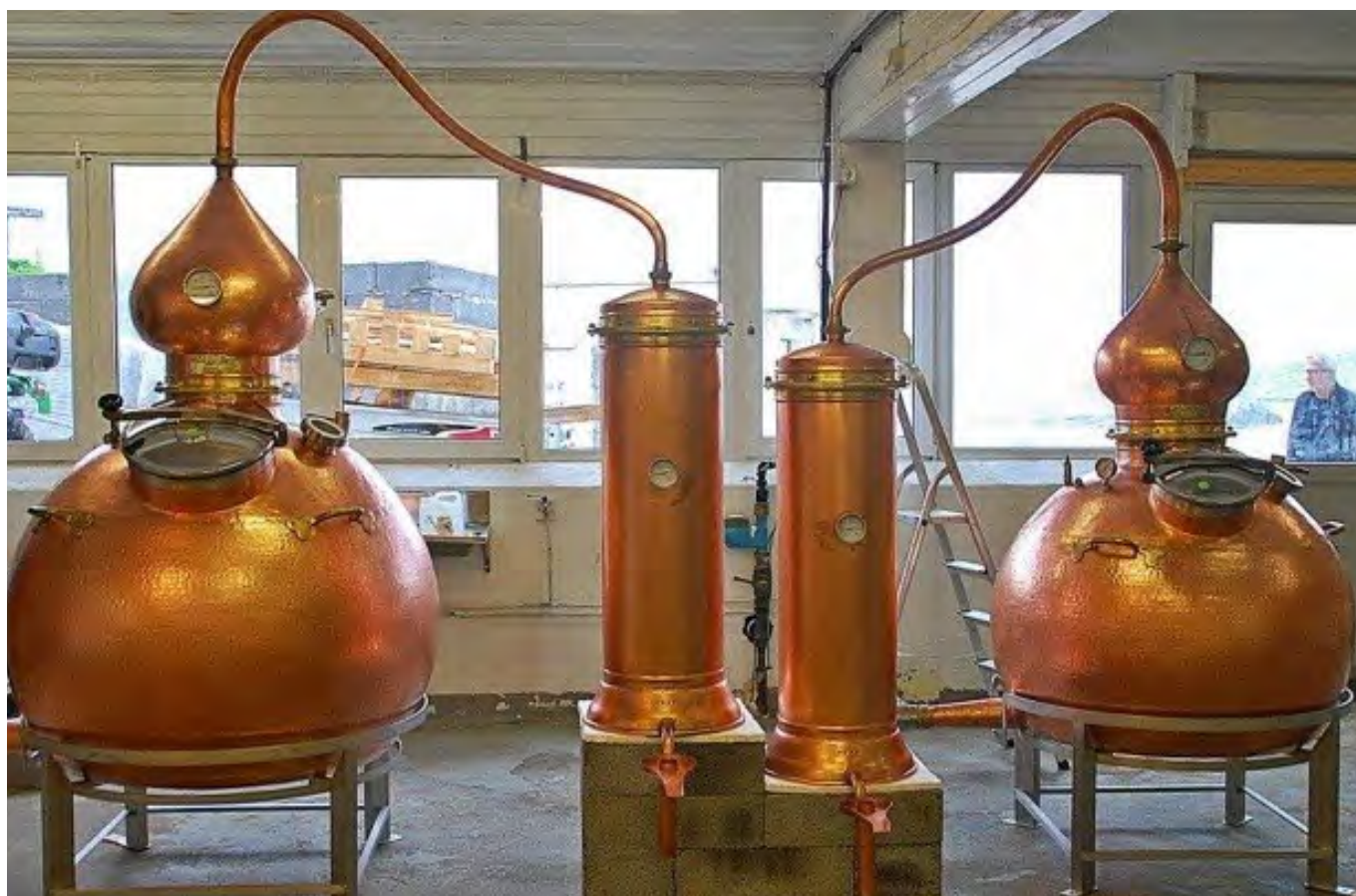
Destilleriets stolthet er pannene i håndbanket kobber fra Spania som brukes til whiskybrenningen.
