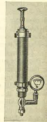
Fig. 182. Tankluftpumpe med manometer (trykmaaler), men uten fotkran.
