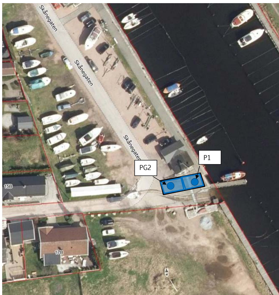
Figur 7. Massedisponeringsplan for dypereliggende naturlig grunn >1 m ved PG1, og >0,8 m ved PG2.
