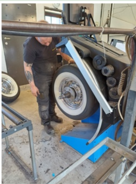
Også tilsynelatande gode dekk kan ha så mykje kast i seg at det er frykteleg å køyre på alt over 70 km/t. Desse ca 20 år gamle dekkna var kassable sjølv om dei såg bra ut etter kanskje 10.000 km.
