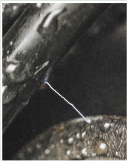
Straumen går minste motstands veg. Er det dårleg kontakt på pluggen kan høgspennten like godt hoppe til bensinpumpa om den er nærme nok.
