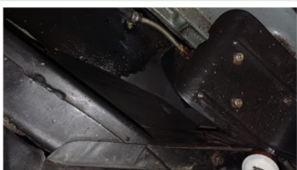
Det lukta bensin av denne bilen etter årets fyrste oppstart, og etterkvart fann eg tre slangar frå ca 2010 som var dårlege.
