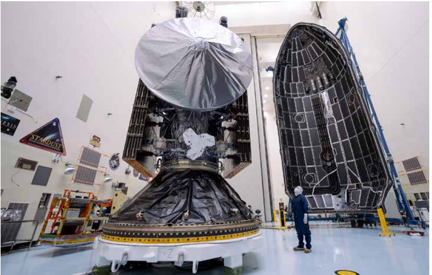
↑ REN: Europa Clipper i et renrom ved Kennedy-senteret før den kapsles inn i nyttelastdekslet til Falcon Heavy. Den runde direktivantennen, som dekket av beskyttende folie, har en diameter på 3 meter.
